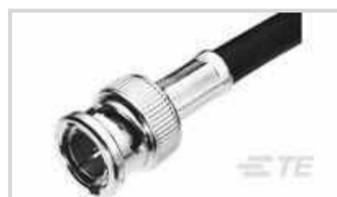
HF-Schnittstelle: **BNC**HF-SteckverbinderAusführung: **Stecker**HF-Steckverbinder Außendurchmesser gesteckt (ca.): **14.53 mm [ .572 in ]**Impedanz: **75 Ω**Mit HF-Kabeltyp kompatibel: **RG 59, RG 59A, RG 59B**
