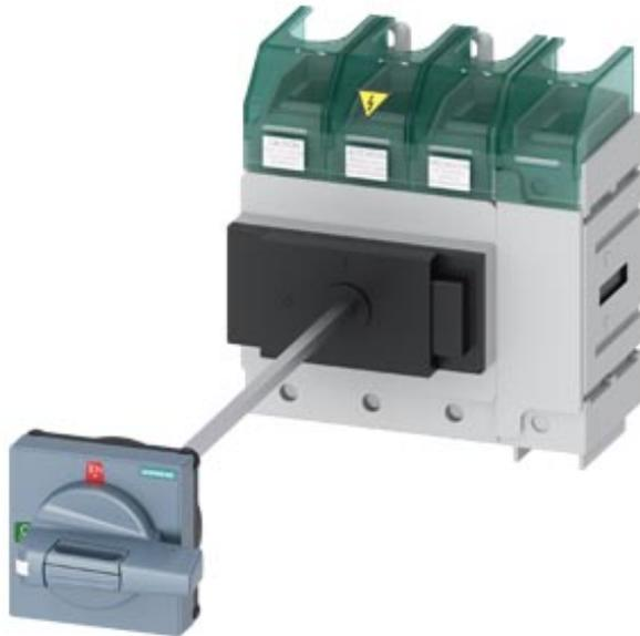
SETRON, Lasttrennschalter 3LD5 UL, Hauptschalter, 4-polig, approbiert nach UL489, UL60947-4-1 und IEC60947-3, UL: 150A, SCCR 50kA at 480VAC, Betriebsleistung @ 480VAC 3-phasig: 100hp, IEC: 160A, Betriebsleistung bei AC-23A bei 400V: 75kW, Bodenbefestigung mit Türkupplung, überlistbarer Drehantrieb, Standard, 4-Loch Befestigung der Handhabe, ohne Toleranzausgleich, inklusive Klemmenabdeckungen für die Einspeiseseite
