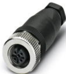
Sensor-/Aktor-Stecker, Buchse, gerade, 5-polig, M12, A-codiert, Schraubanschluss, Metallrändel, Kabelverschraubung Pg7
