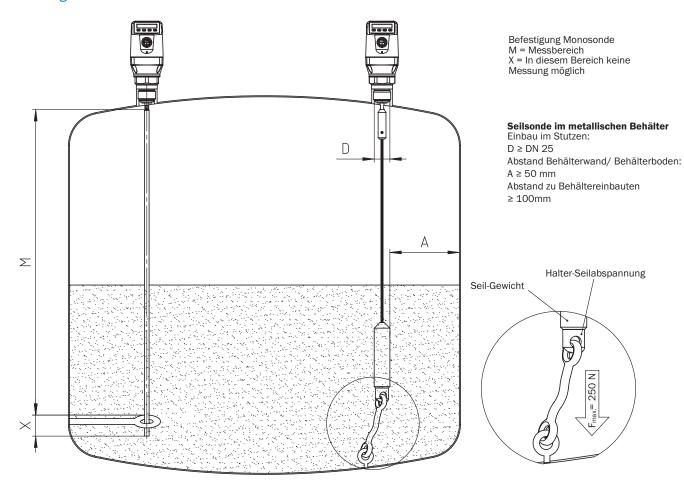
Einbau in ein metallisches Tauchrohr oder metallischen Bypass
