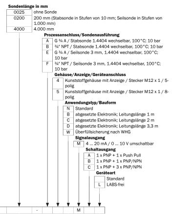
Nicht alle Varianten des Typenschlüssels sind miteinander kombinierbar! Abhängigkeit zwischen der Länge der Koaxialleitung und der Sondenlänge
