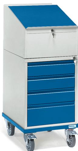
Écritoire en tôle d'acier, revêtement époxy caisson gris RAL 7035, armature et ouvertures RAL 5007. Placard roulant à tiroirs verrouillable, avec écrioire en tôle d'acier. Hauteur écrioire 1050/1200 mm. 2 roues pivotantes et 2 roues fixes à bandage TPE, moyeu à roulement à billes central. Freins sur roues pivotantes conformément à la Norme EN 1757-3. Charge maximum par tiroir 25 kg.
