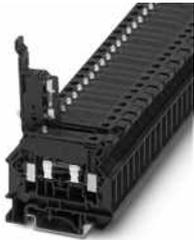
Sicherungsreihenklemme, Art der Sicherung: Glas / Keramik / ..., Sicherungstyp: G / 5 x 20, Nennspannung: 500 V, Nennstrom: 6,3 A, Polzahl: 1, Anschlussart: Schraubanschluss, Bemessungsquerschnitt: 1,5 mm<sup>2</sup>, Querschnitt: 0,2 mm<sup>2</sup>- 6 mm<sup>2</sup>, Montageart: NS 35/7,5, NS 35/15, NS 32, Farbe: schwarz
