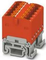
Verteilerblock, die Blöcke sind untereinander über den Leiterschacht brückbar, passende Steckbrücken siehe Zubehör, intern gebrückt, Nennspannung: 500 V, Nennstrom: 17,5 A, Anschlussart: Push-in-Anschluss, Querschnitt: 0,14 mm<sup>2</sup> - 2,5 mm<sup>2</sup>, Montageart: NS 15, Farbe: rot
