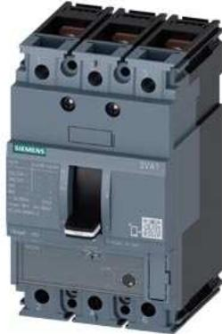
Leistungsschalter 3VA1 IEC Frame 160 Schaltvermögenklasse M Icu=55kA @ 415V 3-polig, Starterschutz TM120M, AM, In=100A ohne Überlastschutz Kurzschlusschutz Ii=7...16 x In Schraubenflächanschluss
