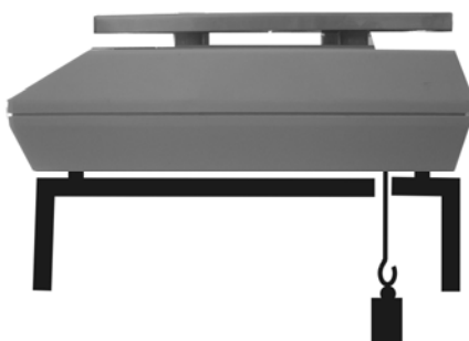
Fig. 1: Preparazione della bilancia per pesature a ponte
