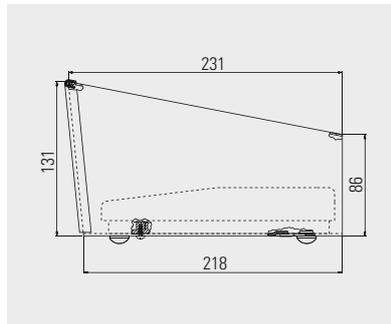
Schutzhaube aus Stahlblech in der Farbe Orange ähnlich RAL 2004 mit Kantenschutzband und Gummifüßen sowie Befestigung für Fußschalter des Grundtyps 2410
