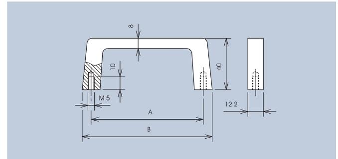
Einschließlich Zylinderschrauben-M5 x 12 und Scheiben.
