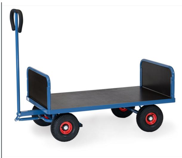
En tube d'acier soudé, revêtement époxy bleu RAL 5007. plateau en contreplaqué hydrofuge, avec 2 ridelles petits côtés hauteur 300 mm, châssis en tube d'acier. Essieu avec timon et poignée. Roues gonflables, moyeu à roulement à rouleaux. Poignée sécurisée avec revêtement souple remontant automatiquement en position verticale. Blocage automatique de l'essieu avant, conformément à la Norme EN 1757-3.
