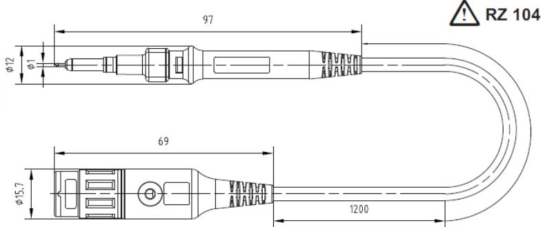
Sicherheits-Hochfrequenz-Tastkopf 100:1 in kompakter Bauform. Durch geringe Eingangskapazität und grossen Eingangswiderstand ist dieser Tastkopf besonders geeignet für Messungen an empfindlichen Schaltkreisen. Hoch flexible, PVC-isolierte koaxiale Anschlussleitung mit BNC-Stecker mit integrierter Kompensationseinheit. Anschlussmöglichkeit für Referenzleitung am Vorderteil des Tastkopfes.
