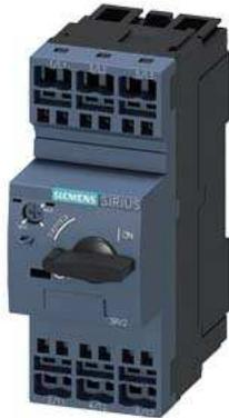
Sondertyp Leistungsschalter Baugröße S0 für den Motorschutz, CLASS 10 A-Auslöser 0,7...1 A N-Auslöser 13 A Federzuganschluss Standardschaltvermögen Umgebungstemperatur -50 °C 500 Schaltspiele
