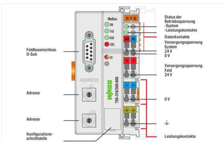
Dieser Feldbuskoppler verbindet das WAGO-I/O-SYSTEM als Slave mit dem MODBUS-Feldbus.
