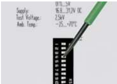
Konfiguration über DIP-Schalter
