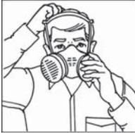
Nach dem Aufsetzen der Halbmaske über Mund und Nase, ist die Kopfbedänderung gemäß der Abbildung anzulegen.
