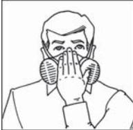
**Überprüfung durch Überdruck:** Legen Sie die Handfläche über das Ausatemventil und atmen Sie langsam aus. Wenn keine Luft zwischen dem Maskenkörper und dem Gesicht entweicht, wurde ein ordnungsgemäßer Sitz erzielt. Ansonsten muß der Maskensitz oder die Spannung der Bänder korrigiert werden.
