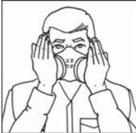
**Überprüfung durch Unterdruck:** Verschießen Sie die Öffnungen der Filtergehäuse mit der Handfläche und atmen Sie langsam ein. Wenn sich der Maskenkörper leicht zusammenzieht, wurde ein ordnungsgemäßer Sitz erzielt. Ansonsten muß der Maskensitz oder die Spannung der Bänder korrigiert werden.
