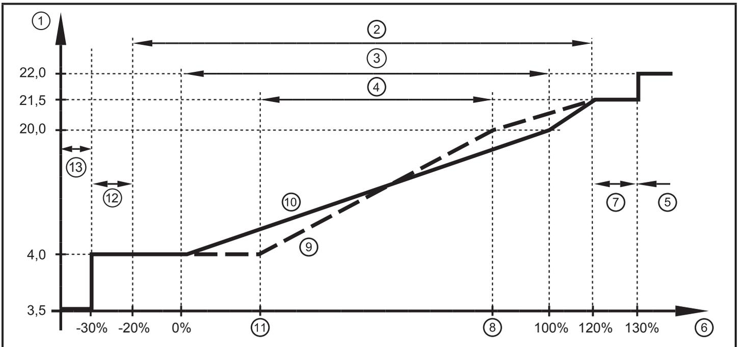
Ausgangskennlinie Analogausgang nach Norm IEC 60947-5-7
