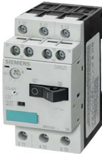
LEISTUNGSSCHALTER BGR. S00, FUER DEN MOTORSCHUTZ, CLASS 10, A-AUSL. 0,9...1,25A,N-AUSL. 16A 1S+10E QUERLIEGEND, SCHRAUBANSCHLUSS, STANDARDSCHALTVERM.
