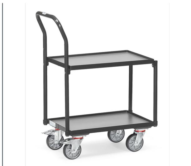
Construction en profilé d'acier, revêtement époxy gris anthracite RAL 7016. 2 plateaux en mélaminé surface gris moyen avec rebord de 15 mm et dossier de poussée, distance entre les plateaux : 400 mm. Hauteur totale : 960 mm. 4 roues pivotantes à bandage TPE, moyeu à roulement à billes central. 2 roues avec freins conformément à la Norme EN 1757-3. Compatibles pour bacs plastiques 600 x 400 mm.
