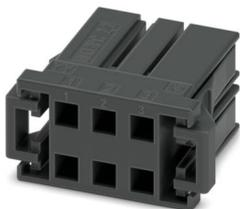
Leiterplattenstecker, Farbe: schwarz, Nennstrom: 8 A, Bemessungsspannung (III/2): 320 V, Kontaktart: Buchse, Anzahl der Reihen: 2, Polzahl: 6, Artikelfamilie: DD32PC 2,2/..., Rastermaß: 5,08 mm, Anschlussart: Crimpanschluss, Anschlussrichtung Leiter/Platine: 0 °, Rasthaken: - ohne Rasthaken, Stecksystem: CONNEXIS DD, Verriegelung: Rastverriegelung, Befestigungsart: Rastflansch, Verpackungsart: verpackt im Karton
