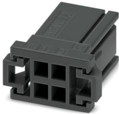
Leiterplattenstecker, Farbe: schwarz, Nennstrom: 8 A, Bemessungsspannung (III/2): 160 V, Kontaktart: Buchse, Anzahl der Reihen: 2, Polzahl: 4, Artikelfamilie: DD31PC 2,2/..., Rastermaß: 3,81 mm, Anschlussart: Crimpanschluss, Anschlussrichtung Leiter/Platine: 0 °, Rasthaken: - ohne Rasthaken, Stecksystem: CONNEXIS DD, Verriegelung: Rastverriegelung, Befestigungsart: Rastflansch, Verpackungsart: verpackt im Karton
