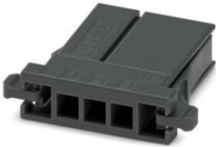
Leiterplattenstecker, Farbe: schwarz, Nennstrom: 8 A, Bemessungsspannung (III/2): 160 V, Kontaktart: Buchse, Anzahl der Reihen: 1, Polzahl: 3, Artikelfamilie: D31PC 2,2/..., Rastermaß: 3,81 mm, Anschlussart: Crimpanschluss, Anschlussrichtung Leiter/Platine: 0 °, Rasthaken: - ohne Rasthaken, Stecksystem: CONNEXIS D, Verriegelung: Rastverriegelung, Befestigungsart: Rastflansch, Verpackungsart: verpackt im Karton
