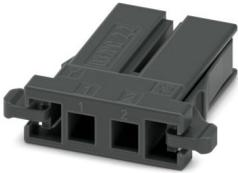
Leiterplattenstecker, Farbe: schwarz, Nennstrom: 8 A, Bemessungsspannung (III/2): 320 V, Kontaktart: Buchse, Anzahl der Reihen: 1, Polzahl: 2, Artikelfamilie: D32PC 2,2/..., Rastermaß: 5,08 mm, Anschlussart: Crimpanschluss, Anschlussrichtung Leiter/Platine: 0 °, Rasthaken: - ohne Rasthaken, Stecksystem: CONNEXIS D, Verriegelung: Rastverriegelung, Befestigungsart: Rastflansch, Verpackungsart: verpackt im Karton
