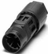
QUICKON Leitungsbinder, grau, 4+PE-polig, 1,0 mm<sup>2</sup> ... 2,5 mm<sup>2</sup> / 690 V / 20 A, für Kabeldurchmesser 6 mm ... 11 mm.
