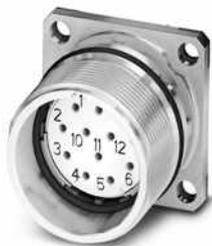
Gerätesteckverbinder, Vorderwand, CA, gerade, geschirmt: ja, für Standard- und SPEEDCON-Verriegelung, M23, Polzahl: 17, Kontaktart: Buchse, Einlötlanschluss, Flachdichtung, 4x Ø 3,2, Flanschmaß: 25 mm x 25 mm, Kodierung:N
