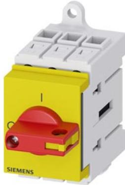
Lasttrennschalter 3LD3, Iu 32 A Hauptschalter 3-polig Bemessungsbetriebsleistung bei AC-23 A bei 400V 11,5kW Verteilereinbau Basisschalter mit Knebelantrieb rot/gelb
