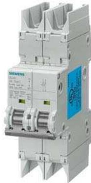
Leitungsschutzschalter 10kA, 2-polig, D, 6A nach UL 489-480Y/277V
