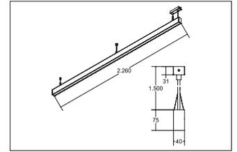
LED-Pendel-Profilleuchte direkt/indirekt BIRO40, silber, rechteckigAusführung: LED, Montageart: Pendelmontage, Montageort: Deckenmontage, Material: Aluminium / Acryl, Schutzart: nach DIN EN 60529: IP20, Schutzklasse: (EN 61140) I, Spannung: 230V AC 50Hz, Leistung: 94.9W, Lichtstrom: 11.580lm, Farbtemperatur: 4000 K, Lichtfarbe: weiß, Abstrahlwinkel: 80°, Verstellbarkeit: nicht verstellbar, mit Betriebsgerät, Art der Dimmung: DALI .
