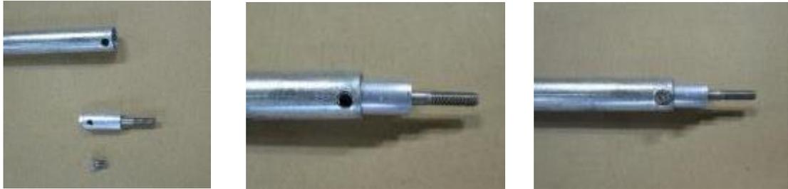
Das Bodenrohr zwischen die Netzbügel in die vorgesehenen Bohrungen einsetzen, jeweils 1 Stck. Flügelmutter M8, DIN 315 aufschrauben und fest anziehen (siehe Fotos unten).
