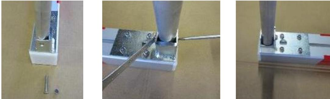
Montage Netzbügel unten - Tor in Bodenhülse Art.-Nr. 1136513:
