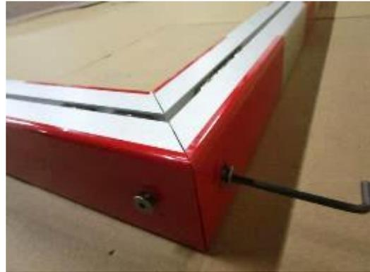
Hinweis: Aufgrund von Fertigungstoleranzen der Alu-Gusseckverbinder kann es in seltenen Fällen vorkommen, dass sich die Ecke nicht exakt ausrichten lässt. Dann die Prägungen im Pfosten mit einer Flachfeile etwas kürzen.
