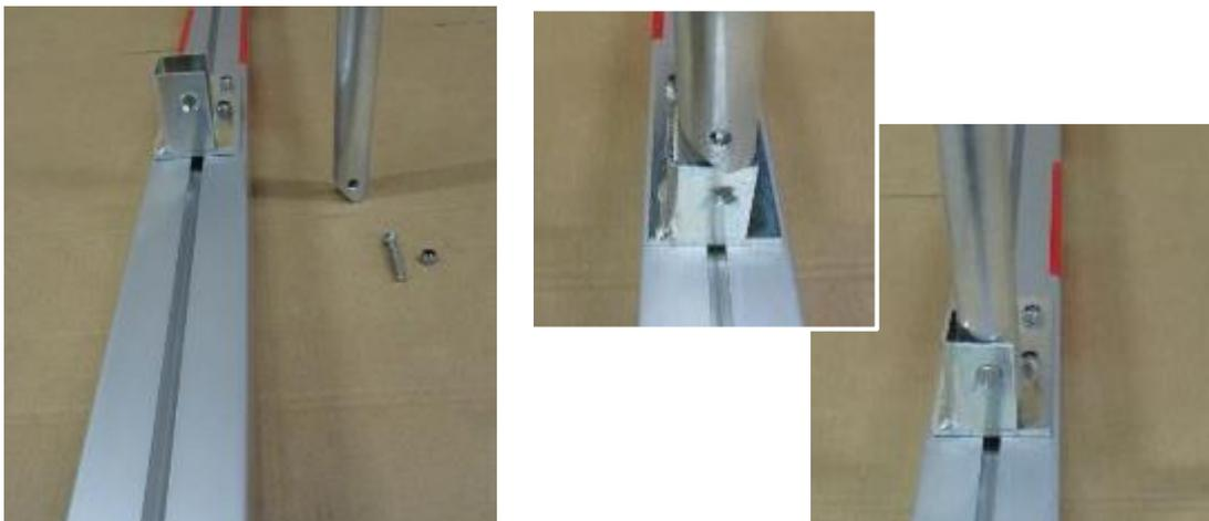
h) Montage Gewindingöse: Durch vordere seitliche und obere Netzbügelbohrungen von innen nach außen jeweils 1 Stck. Gewindingöse M8 x 50 mm stecken und mit 1 Stck. selbstsichernder Hutmutter M8, DIN 986 befestigen (siehe Foto unten).
