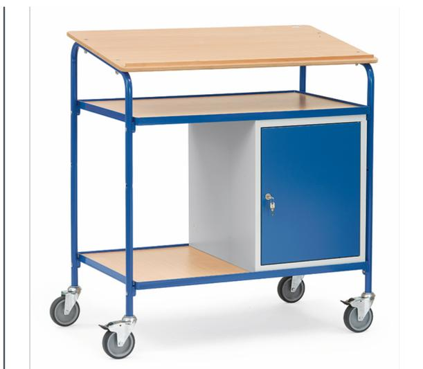
Ensemble mécano-soudé et boulonné, revêtement époxy bleu RAL 5007, dimensions écriture (l x P) : 1100 x 590 mm avec rebord, 1 placard en tôle d'acier verrouillable (L X P X H : 500 x 600 x 600 mm) avec porte, 2 plateaux réglables. 4 roues pivotantes dont 2 avec freins, moyeu à palier lisse. Charge maximum par plateau : 50 kg.
