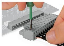
Leiter anschließen – Betätigung des CAGE CLAMP®-Anschlusses mit Schraubendreher (Klingenbreite 3,5 mm) – rechtwinklig zur Leiteranschlußrichtung.
