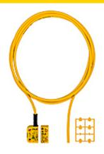
RFiD Sicherheitsschalter 2 sichere HL-Ausgänge, Anschlusskabel 5 m, eine Betätigungsrichtung, Unterstützung für SDD, IP6K9K, Schaltabstand 11 mm, Sao = 8 mm, Sar = 20 mm, VP = 1 Stück vollcodierter Schalter mit Betätiger. Es sind insgesamt 8 Einlernvorgänge möglich.
