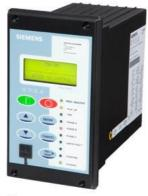
7SR105 Gehäuse, Ein-/Ausgänge und Gerätefront: S4 Gehäuse, 4Str.Wdl, 6 BE/B BA, 10 LEDs; Messeingänge: 1/5 A, 50Hz; Hilfsspannung: AC/DC 60-240 V, Schwelle Binäreingang AC/DC 44 V; Standardversion, keine Abdeckung; Kommunikation: USB-Schnittst. vorn, RS485-Schnittst. hinten; Eingang: 6 Thermobox-Eingänge; Standardversion – mit Leistungsschaltersteuerung; Schutzfunktionspaket: Standardfunktionen (in allen Ausführungen enthalten); Zusatzfunktion: Temperatureingang
