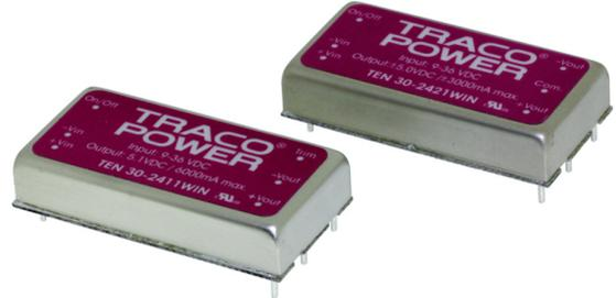
Die TEN 30WIN Serie bietet sehr leistungsfähige 30 W DC/DC-Konverter mit einem sehr weiten 4:1 Eingangsbereich in einem ultrakompakten Gehäuse mit Industriestandard-Pinning an. Standardmerkmale dieser Serie sind die externe Ein/Aus-Funktion, die einstellbare Ausgangsspannung, Überspannungs- und Kurzschlußschutz sowie die Unterspannungsabschaltung.
