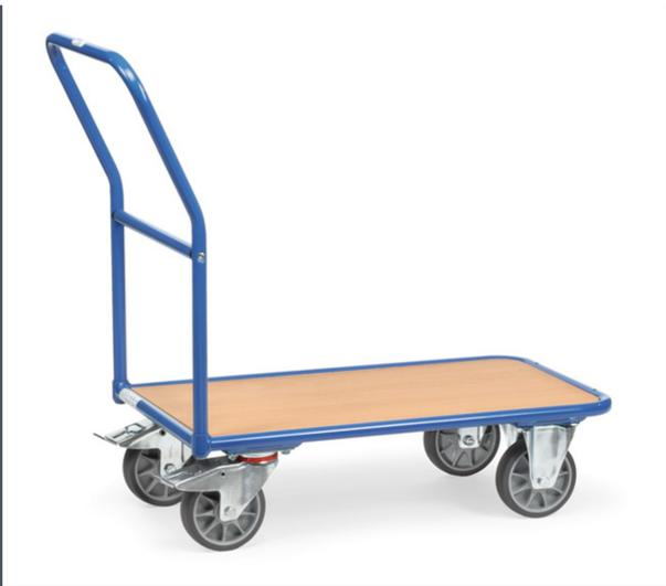
Stahlrohr, Schweißkonstruktion, pulverbeschichtet, blau RAL 5007. Plattform Holzwerkstoffplatte, Oberfläche Buchendekor. 2 Lenk- und 2 Bockrollen, TPE-Bereifung, Naben mit Rillenkugellager. Feststeller an den Lenkrollen, gemäß der Europäischen Norm EN 1757-3 (Sicherheit von Plattformwagen).
