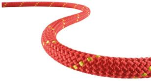
Dank seines höheren Mantelanteils und dem 40er Mantelgeflecht ist das Tutor XG sehr robust und weist außerdem sehr hohe Bruchkräfte in der Vernähung auf. Der eng geflochtene 40er Mantel aus Polyamid bietet höhere Abriebbeständigkeit und schützt den Kern zusätzlich vor dem Eindringen von Verunreinigungen. Das Seil muss dann mit Endverbindungen werkseitig ausgestattet werden (vernähte Schlaufe, eingenähter Karabiner, Endknoten).
