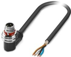
Sensor-/Aktor-Kabel, 4-polig, PUR halogenfrei, schwarzgrau RAL 7021, geschirmt (Advanced Shielding Technology), Stecker gewinkelt M12 Push-Pull, Kodierung: A, auf freies Leitungsende, Kabellänge: 3 m
