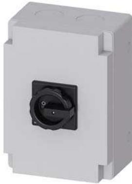
SETRON, Lasttrennschalter 3LD, Hauptschalter, 3-polig, I<sub>n</sub>: 125 A, Betriebsleistung / bei AC-23 A bei 400V: 45 kW, Isolierstoff-Kapselung für metrische Verschraubung, 1Ö, 1S, Drehantrieb, schwarz
