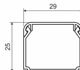
Produktbeschreibung: bestimmt zur Installation von Niederspannungsleitungen
