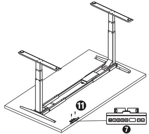
L. Verbinden Sie die Kabel gemäß Abbildung. Damit die Kabel nicht durchhängen verwenden Sie die mitgelieferten Kabelbinder.
