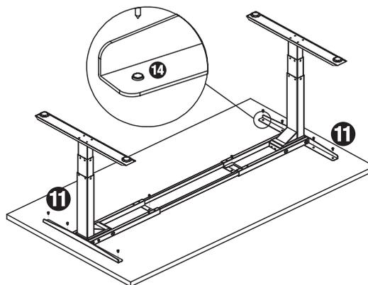
J. Ziehen Sie die Schrauben im nächsten Schritt nicht zu fest an, um Beschädigungen zu vermeiden.
