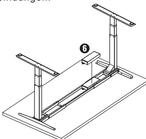
K. Ziehen Sie die Schrauben im nächsten Schritt nicht zu fest an, um Beschädigungen zu vermeiden.
