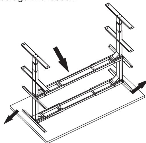
H. Befestigen Sie die Mittelschienen an beiden Enden mit Schrauben(Teil 10), 4 pro Seite.
