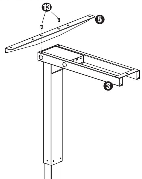
D. Nachdem alle diese Schrauben richtig platziert wurden, können Sie nun die Schrauben (Teil 13) aus Schritt C und die in Schritt B beschriebenen Schrauben (Teil 10) anziehen (insgesamt 12 Schrauben).
