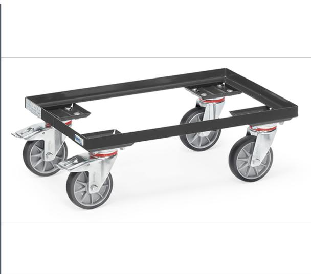
Construction en profilé d'acier, revêtement époxy gris anthracite RAL 7016. Rouleur à armature ouverte. 4 roues pivotantes à bandage TPE, moyeu à roulement à billes central. 2 roues avec freins conformément à la Norme EN 1757-3. Compatible pour bacs plastiques 600 x 400 mm.
