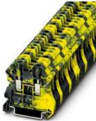
Durchgangsklemme, Nennspannung: 1000 V, Nennstrom: 41 A, Anschlussart: Schraubanschluss, Querschnitt: 0,14 mm<sup>2</sup> - 6 mm<sup>2</sup>, Montageart: NS 35/7,5, NS 35/15, Farbe: schwarz/gelb
