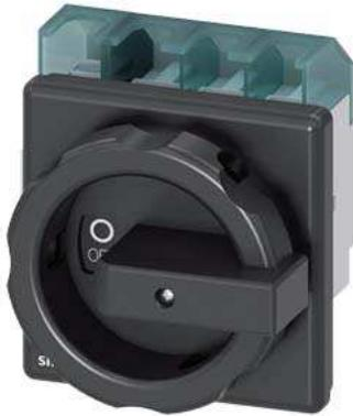
SETRON, Lasttrennschalter 3LD, Hauptschalter, 4-polig, I<sub>n</sub>: 63 A, Betriebsleistung / bei AC-23 A bei 400V: 22 kW, Frontbefestigt, Drehantrieb, schwarz, 4-Loch Befestigung der Handhabe
