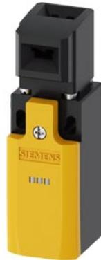
Sicherheits-Positionsschalter mit getrenntem Betätiger Kunststoffgehäuse, 31 mm Geräteanschluss 1x (M20x 1,5) Schleifschaltglieder 1S/2Ö mit 2 LEDs gelb/grün DC 24 V 5 Anfahrrichtungen der dazu passende getrennte Betätiger 3SE5000-0AV0. muss separat bestellt werden
