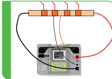
**Beispiel 2:** Prüfung des Übergangswiderstands von Stromschienen. Durch die Verwendung von höheren Strömen kann der Widerstand unter ähnlichen Bedingungen wie im normalen Gebrauch beobachtet werden. Dadurch erhalten Sie ein zuverlässiges Ergebnis das Entscheidung über notwendige Wartungsarbeiten erleichtert.
