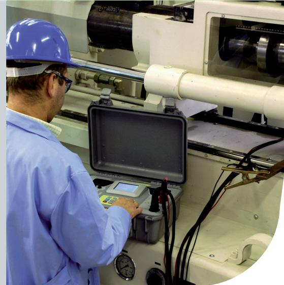
**MI 3252 MicroOhm 100 A ist ein tragbares Messgerät für Messungen von niederohmigen Widerständen mit einem einstellbaren Prüfstrom von 100 mA bis 100 A.**
