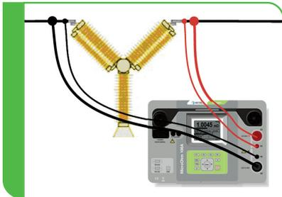
**Beispiel 1:** Prüfung des Kontaktwiderstands von Hochspannungs-Leistungsschalter. Nach der IEC62271-100 sollte dieser Test mit mindestens 50 A Prüfstrom durchgeführt werden.
