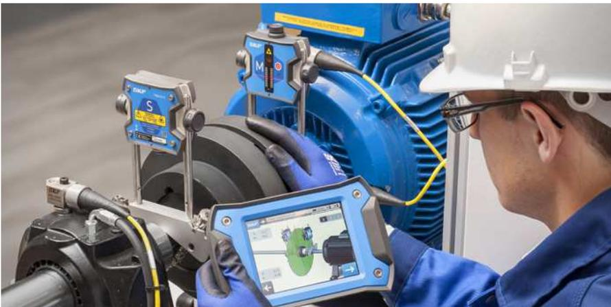
Eine Wellenausrichtung lohnt sich für eine Vielzahl von rotierenden Industriemaschinen. Oft erlaubt die Ausrichtung eine deutliche Verbesserung der Maschinenverfügbarkeit bei gleichzeitiger Reduzierung der Instandhaltungskosten. Das einfache Wellenausrichtungs-System TKSA 41 bietet bei allen Arten von horizontal rotierenden Maschinen größeres Vertrauen bei der Ausführung von Ausrichtungsaufgaben.
