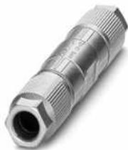
Leitungsverbinder, PROFINET CAT5 (100 MBit/s), 4-polig, halogenfrei, geschirmt, Schneidklemmanschluss, Gehäusematerial: Zinkdruckguss, vernickelt, Kabelaußendurchmesser 5 mm ... 9,7 mm
