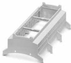
Tragschienengehäuse für den Einsatz in Installationsverteilern nach DIN 43880, Gehäuseoberteil (U11) mit Lüftungsschlitzen, Einbautiefe Anschluss technik: 11,1 mm, Breite: 161,6 mm, Höhe: 89,7 mm, Tiefe: 54,85 mm, Farbe: lichtgrau (7035)
