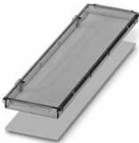
Tragschienegehäuse für den Einsatz in Installationsverteilern nach DIN 43880, transparenter Schwenckdeckel, plombierbar, inklusive Einlegeblende, Breite: 161,6 mm, Höhe: 45 mm, Tiefe: 8 mm, Farbe: transparent/lichtgrau (7035)
