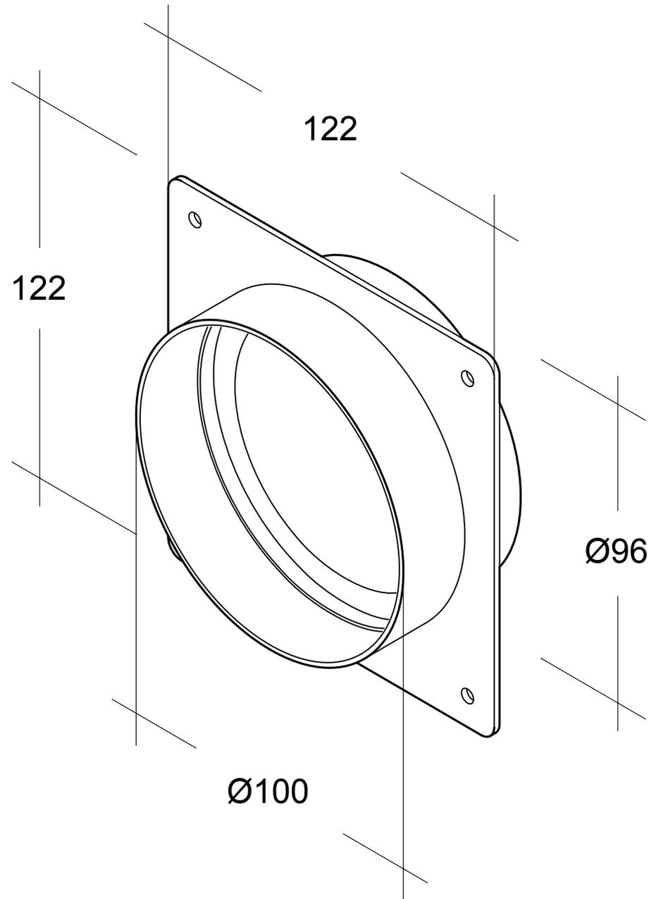
Maueranschlußstutzen rd./rd. NW100, m. RSK
