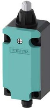
Positionsschalter, 3SE51 mit Kuppenstößel (Edelstahl), Metallgehäuse 40 mm nach DIN EN 50041 1S/1Ö Sprungkontakte mit M12-Stecker, 4-polig, feste PIN-Belegung: PIN1=21, PIN2=22 PIN3=13, PIN4=14
