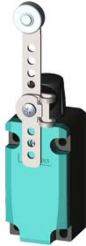
SIRIUS POSITIONSSCHALTER, METALLGEHÄUSE 40MM, NACH EN50041 GERAETEANSCHLUSS 1X (M20X1,5) 1S/ 1OE SPRUNGKONTAKTE SCHWENKANTRIEB RECHTS/LINKS EINSTELLBAR, MIT LAENGEN- VERSTELLB. EDELSTAHLHEBEL 100MM LANG UND MIT FORMSCHLUSS (RASTERBOHRUNG), UND KUNSTSTOFFROLLE 19MM, FUNKTIONSFÄHIG BEI -40 GRAD, SCHOCK- UND SCHWINGPRUEFUNG NACH EN61373, KATEGORIE 1B
