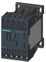
CONTACTOR, AC-3, 5.5KW/400V, 1NC, DC 24V, 3-POLE, SZ S00 SPRING-LOADED TERMINAL .
